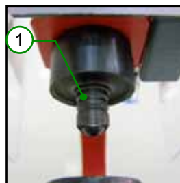
Figura 3.3 - Zona libre de residuos del troquel superior
