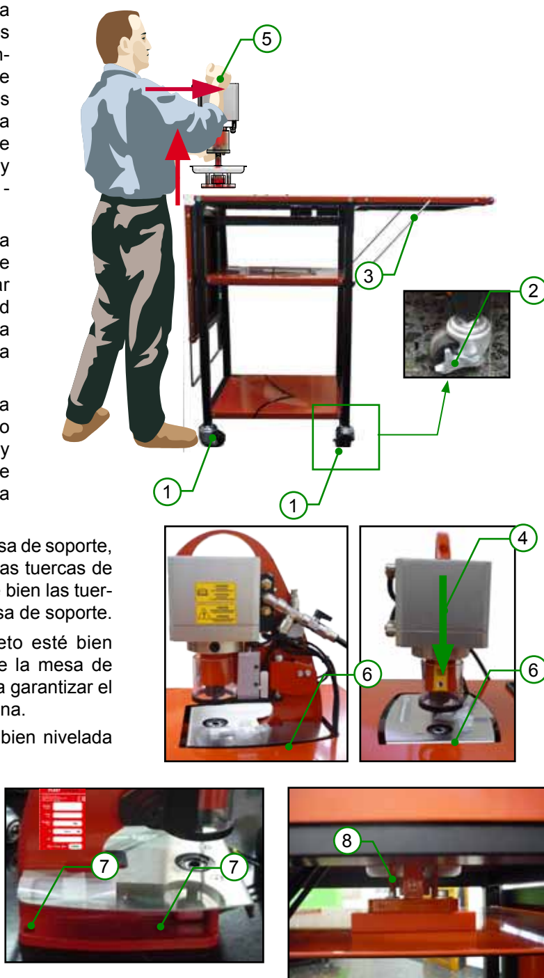
Figura 1.5 - Montaje sobre mesa de soporte
