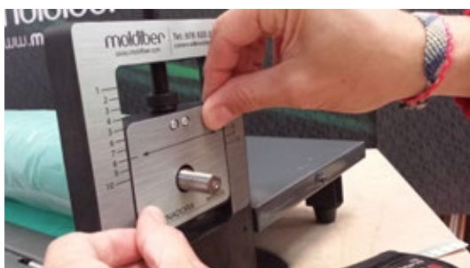
3. Colocación de adhesivo flecha de marca.
