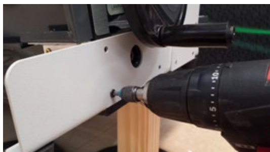
5. Colocación de brazo de sujeción en el cuerpo de la laminadora.
