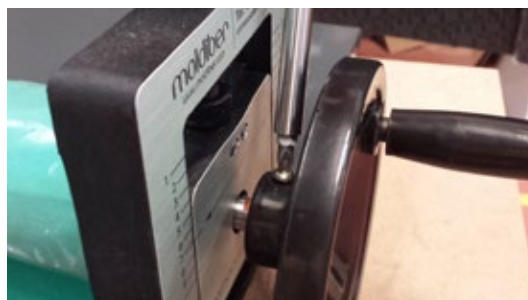
1. El volante se sujeta con un tornillo al eje portarrollos.
