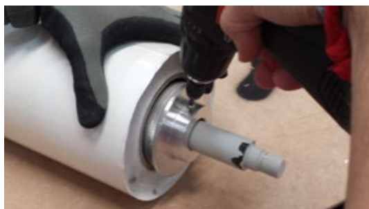
7. Sujeción de pletina adaptadora al eje.
