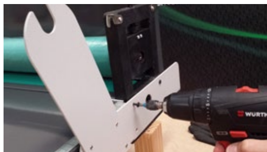
6. Colocación de brazo de sujeción en el cuerpo de la laminadora.
