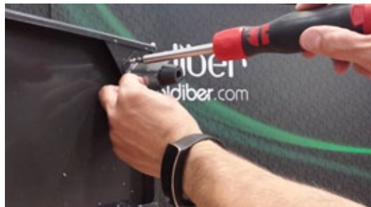
2. Atornillar 2 patas en cada ala de la laminadora.
