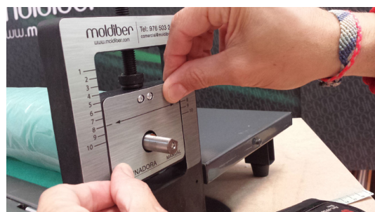
3. Colocación de adhesivo flecha de marca.
